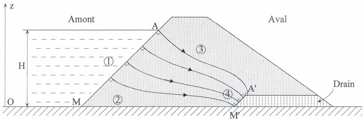
Figure 5. Ecoulement permanent à travers un barrage en terre
