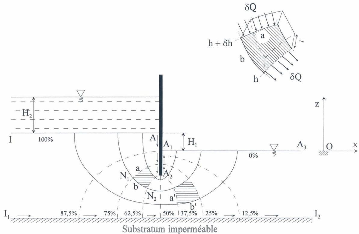
Figure 7. Réseau d'écoulement sous un rideau de palplanches
