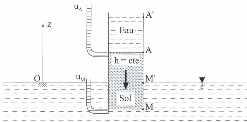
Figure 2. Ecoulement d'eau à travers un sol
