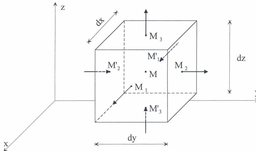
Figure 3. Ecoulement d'eau à travers un volume élémentaire
