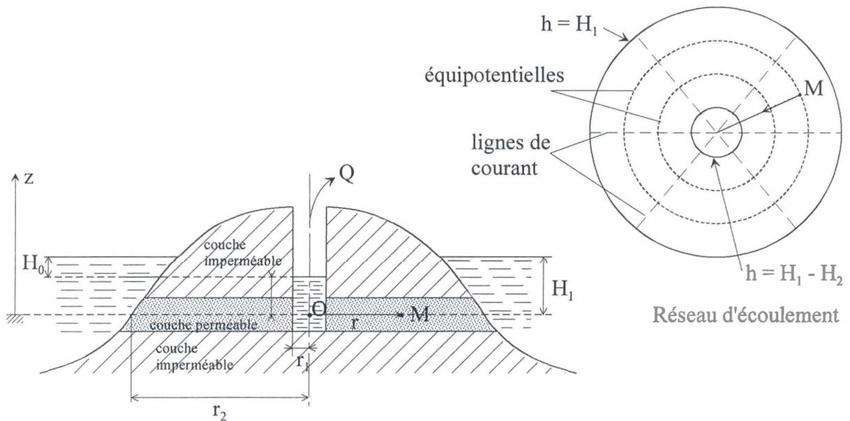
Figure 6. Ecoulement plan à travers une île de révolution
