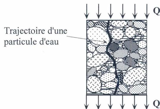
Figure 1. Écoulement unidimensionnel de l'eau dans un sol
