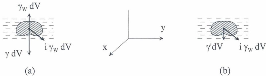
Figure 8. Equilibre d'un élément de sol soumis à un écoulement
