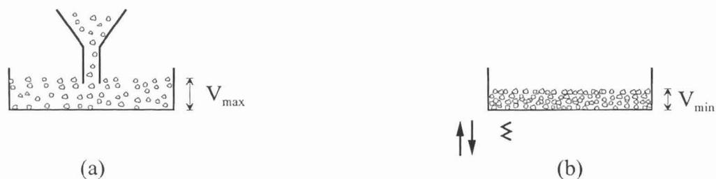
Figure 5. Essai de densité relative
